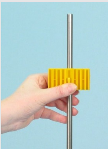
Fijar el soporte del tubo de vidrio a la varilla.
